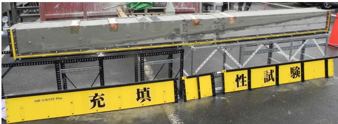
障害物周囲の充填状況
